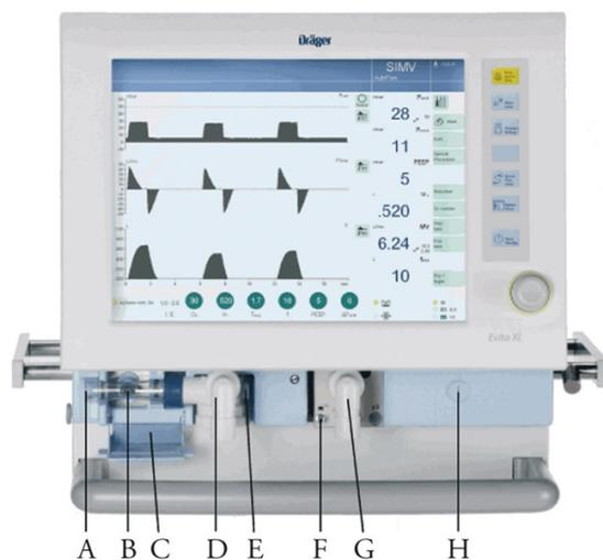
*Figura 2. Visión frontal del equipo con la pantalla y los mandos. A) Boquilla de salida de gases. B) Sensor de flujo. C) Tapa del sensor de flujo. D) Válvula espiratoria con boquilla de conexión espiratoria (GAS RETURN). E) Enganche para la válvula espiratoria. F) Conexión para el nebulizador. G) Boquilla de conexión inspiratoria (GAS OUTPUT). H) Tornillo de fijación para la cubierta de protección (detrás: sensor de O<sub>2</sub> y filtro de aire ambiente).*
